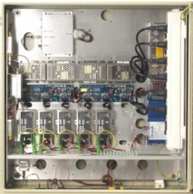
ODE-B と、5 つのモジュール、 内蔵電源&RF スイッチ
